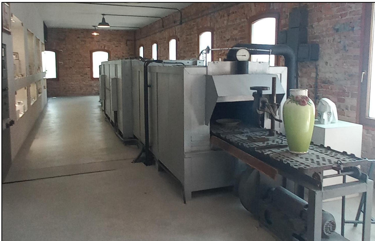
Jeden z „eksponatów” wystawy - piec elektryczny tzw. mufel, który służył do wypalania dekoracji na porcelanie
